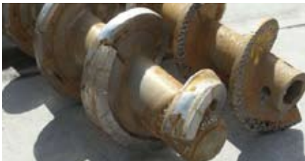
Abraumaustragsschnecke aus VAUTID-Verbundguss GS 45 mit W 7
