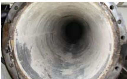
Zylinder für Abraumaustragsschnecke, ausgekleidet mit VAUTID-Verschleiß-Platten V 100
